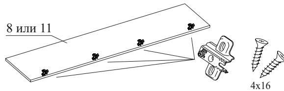
5.2. Установите на детали 8 и 11 дюбеля для эксцентрика. С помощью рычажка разделите направляющие, внешнюю часть закрепите с помощью шурупов 3,5x16. Вставьте полкодержатели.
