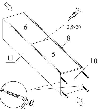
Закрепите детали 10 к деталям 11 и 8 с помощью евровинта 7х50. Вставьте задние стенки в паз получившейся конструкции, закрепите их на стыке с помощью саморезов 2,5\*20
