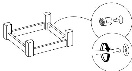
Установите в детали 14 и 13 стяжку коническую. Соедините опоры (дет. 1-4) с деталями 14 и 13 и затяните винт стяжки.
