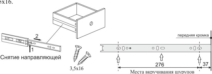
**ВНИМАНИЕ!** В зависимости от производителя направляющие места вкручивания шурупов могут отличаться. Необходимо выровнять направляющие по краю детали.
