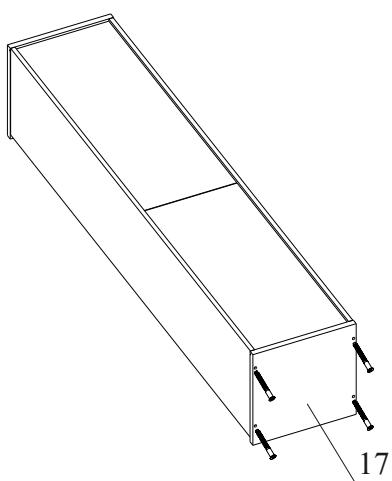
Закрепите дет.17 к получившейся конструкции с помощью евровинта 7\*50.
