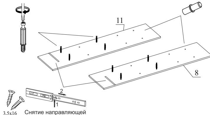
**ВНИМАНИЕ!** В зависимости от производителя направляющих места вкручивания шурупов могут отличаться. Необходимо выровнять направляющие по краю детали.
