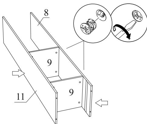
Закрепите деталь 9 между деталями 8 и 11, затяните эксцентрики.
