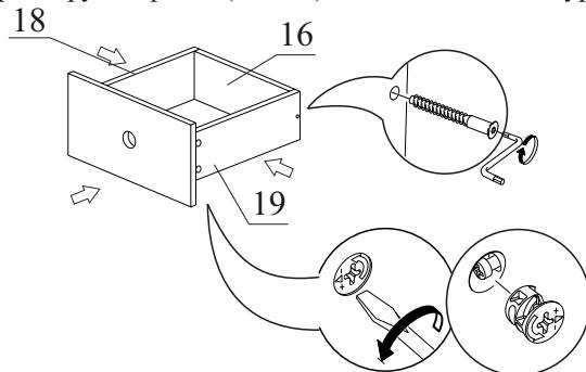
6.1. Выровняйте диагонали ящика, вставьте дно ящика (дет. 7) в паз и закрепите к деталям 16, 18 и 19 с помощью шурупов 2,5x20.
