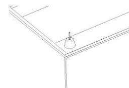
8. Закрепить боковину малую на короб оттоманки при помощи болтов M8x45 – 2 шт. Болты крепить через усовые гайки.
