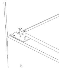
4. Закрепить опору колесную на внутренней стороне сиденья как показано на (рис), при помощи винтов M6x20 – 4шт.
