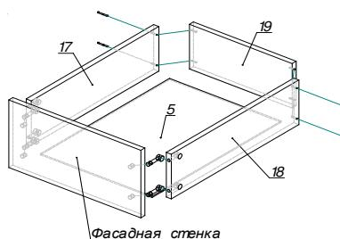
Соединить стенки ящика боковые поз.17,18 со стенкой ящика задней поз.19 шурупами 4\*30 поз.006. Соединить фасадную стенку ящика (из упаковки с фасадами) с боковыми стенками ящика поз.17,18. Установить дно ящика поз.5 и шариковые направляющие поз.045 на шурупах 3,5x16 на боковые стенки ящиков. Вставить ящики в проем, соединив шариковые направляющие, вставив их друг в друга, пока не раздастся щелчок (см.рис.4).
