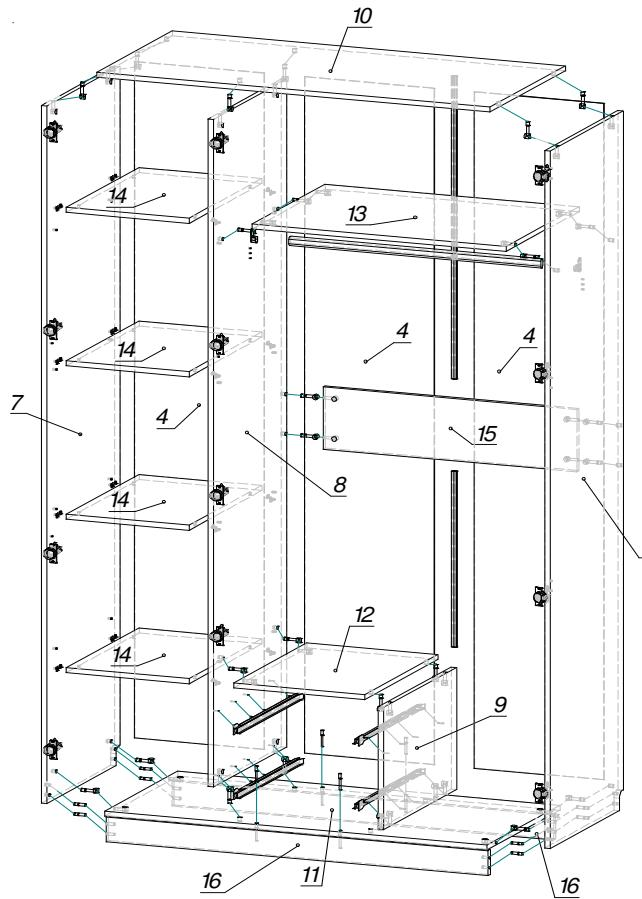
**Схема установки направляющих
