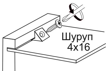
3. Закрепите к детали №4 боковину ящика №3 и боковину №8 с помощью евровинтов, затем вставьте дно ящика № 1 в пазы и закрепите фасад ящика №15. Закрепите ответные планки направляющих к боковинам ящика как показано на схеме 2.
