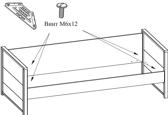
6.3. Закрепите профиль (дет. 4) к детали 3 вставив и затянув эксцентрики.
