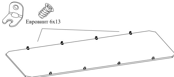
**6. Сборка кровати. ВНИМАНИЕ!** При сборке избегать неосторожных ударов и излишних усилий. Сборку производить в горизонтальном положении.
