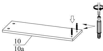
6.8. Закрепите деталь 11 между деталями 10 и 10а вставив и затянув эксцентрики.
