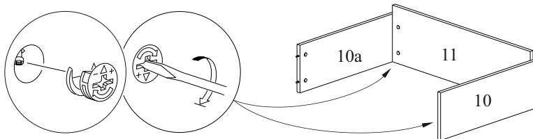
6.9. Закрепите детали 10, 10а к стенке боковой вставив и затянув эксцентрики. Закрепите деталь 11 к дну (дет. 1) с помощью евровинтов 7x50.
