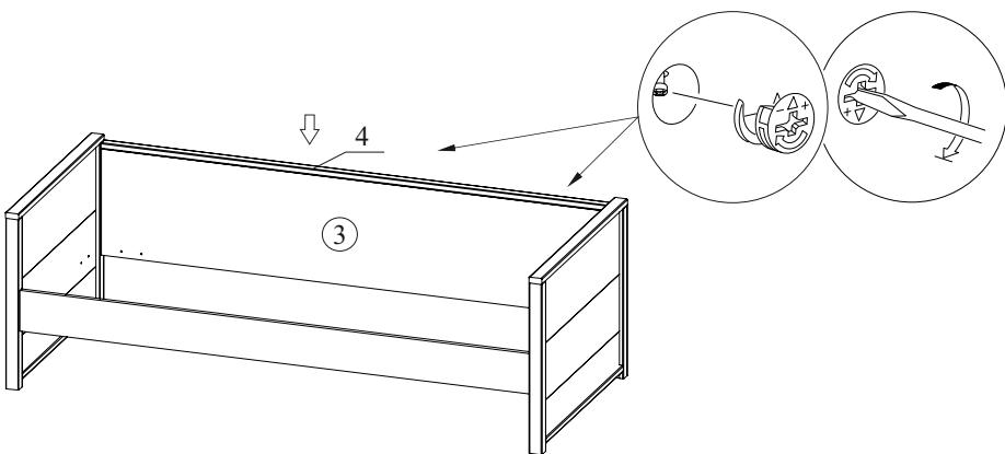
6.4. Аккуратно установите кровать на заднюю стенку. Вставьте дно (дет. 1) и закрепите с помощью стяжек угловых и евровинтов 6x13. Наклейте войлочные под пятники на торцы опор.
