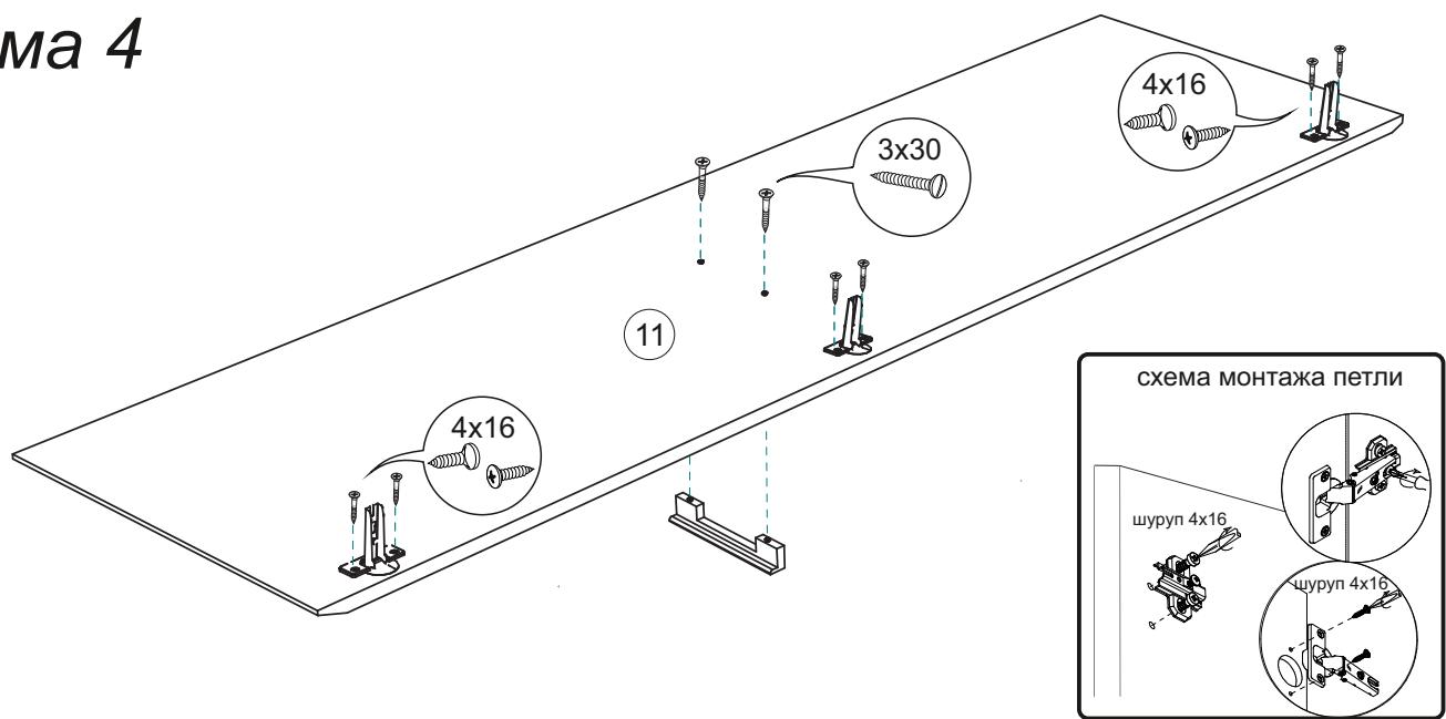
**6.** Повесьте шкаф на место, затем при помощи евровинтов соедините полку со шкафом, для этого приверните полки 4 к боковине 7 и придерживая полку, прикрепите её к стене.
