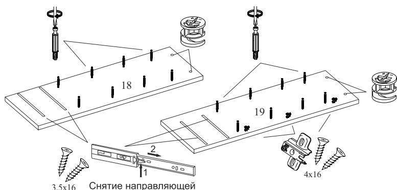
**ВНИМАНИЕ!** В зависимости от производителя направляющих места вкручивания шурупов могут отличаться. Необходимо выровнять направляющие по краю детали.
