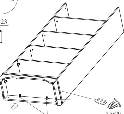
Закрепите между собой детали 22, 23, 23а и 26, затянув эксцентрики.
