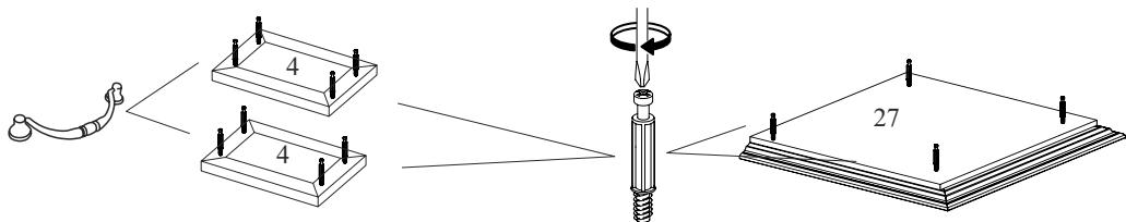
5.5. Для пенала закрепите петли на дверях (дет. 9) с помощью шурупов  $4 \times 16$ .
