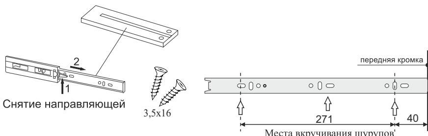
**ВНИМАНИЕ!** В зависимости от производителя направляющие места вкручивания шурупов могут отличаться. Необходимо выровнять направляющие по краю детали.
