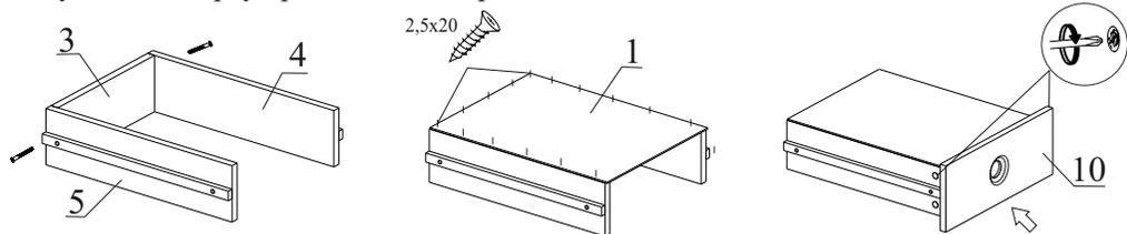
Закрепите детали 3, 4 и 5 с помощью евровинтов 7x50
