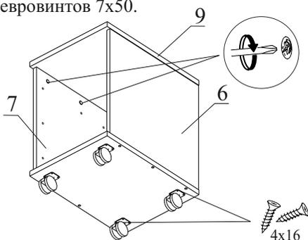
Закрепите деталь 9 к деталям 6 и 7, затяните эксцентрики. Установите опоры колесные с помощью шурупов 4x16.
