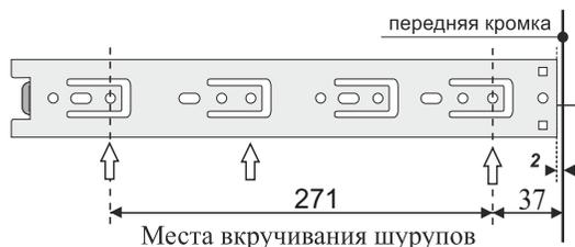
7.2. Вставьте эксцентрики в отверстия  $\phi 15 \times 13$  на деталях 4 и 5. Закрепите внутреннюю часть направляющих с помощью шурупов 3,5x16.
