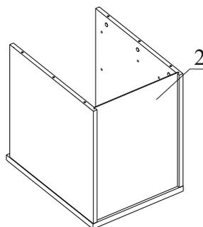
Вставьте задник тумбы поз.2 в пазы боковых стенок и дна.
