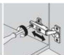
Регулировка по глубине 7
