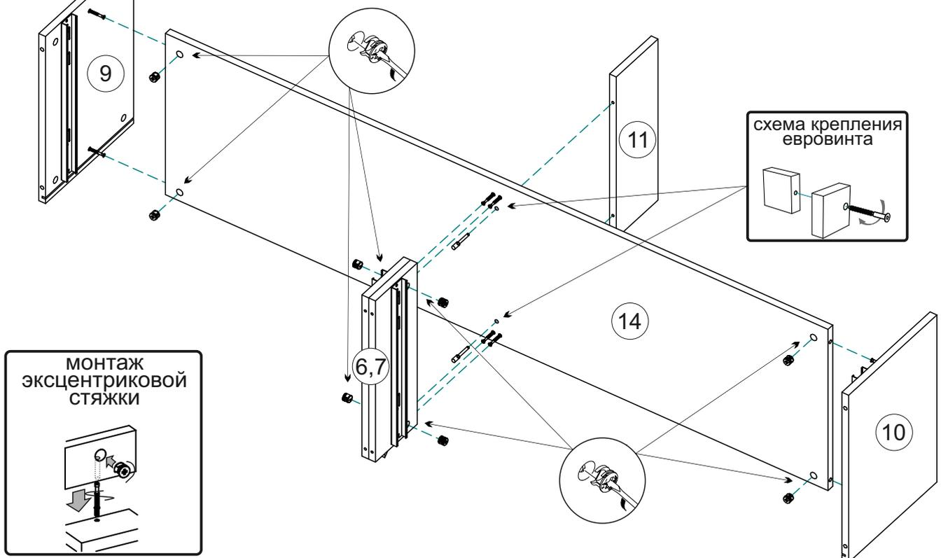
4. Соедините крышку 12 с боковинами 9,10 эксцентриковой стяжкой и с перегородками 6,7 евроинтами (схема 3).
