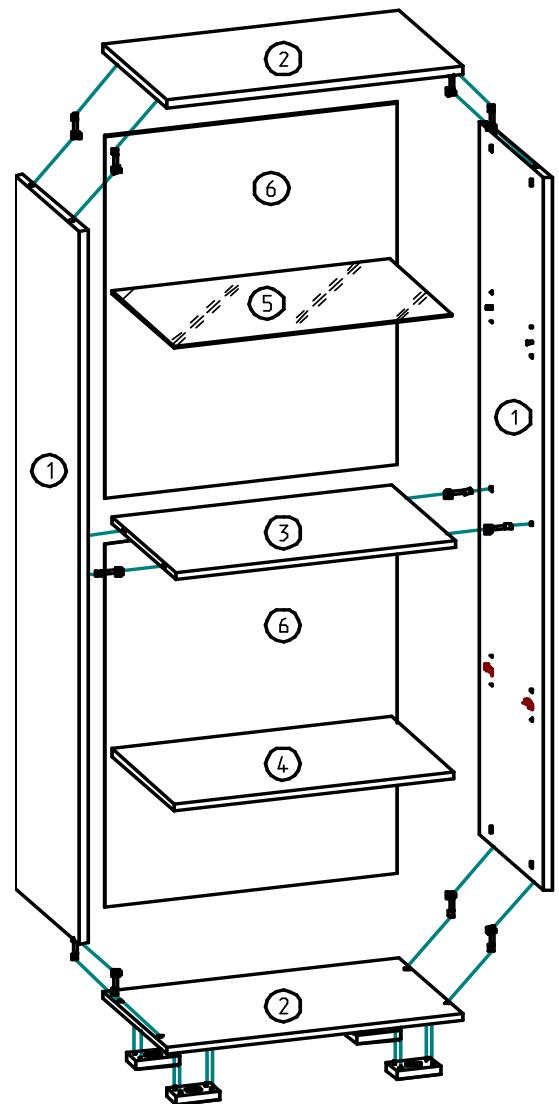
Схема сборки каркаса шкафа (рис.1)
