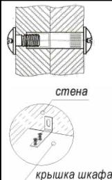
**При установке 2-х шкафов рядом, стянуть их между собой межсекционной стяжкой поз.033, для чего необходимо просверлить в стенках боковых сквозные отверстия Ф5 мм.**
